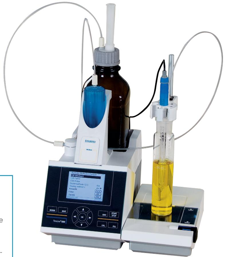
Abbildung zeigt die Titrationsanwendung „Chemischer Sauerstoffbedarf“, CSB
